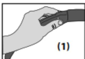
Za odklepanje parnega čistilca pritisnite varnostni gumb na desni strani (1).
