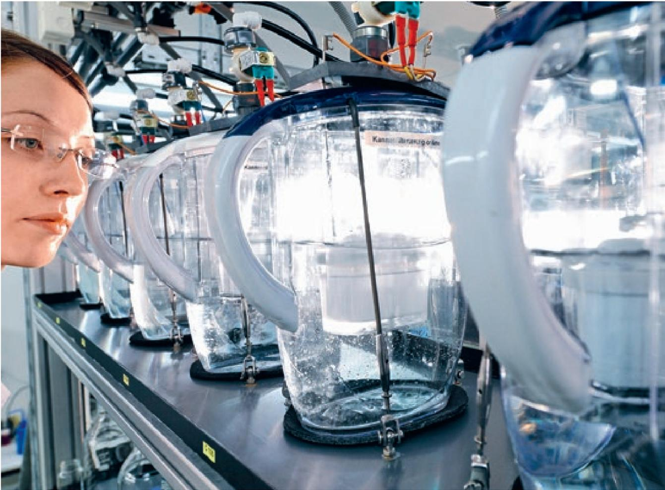
Messung der Filterabscheideleistung auf dem vollautomatischen Kannenfilter-Prüfstand.
